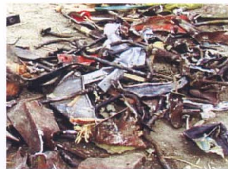
廃材より分離された金属を強力に除去。 下の写真は磁選機により除去された金属類。
