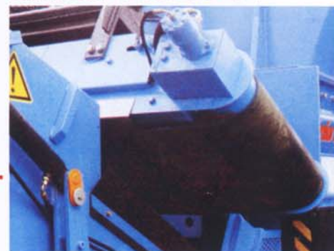
廃材より分離された金属を強力に除去。 下の写真は磁選機により除去された金属類。
