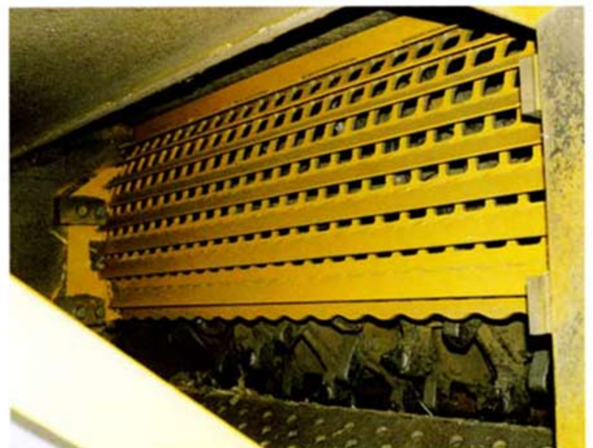
均等 (短い) チップが出来るバフルスクリーン。50%角穴と76%角穴の2種があります。
