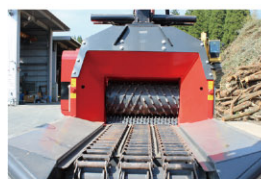
材料供給装置
