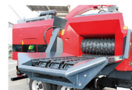
材料供給装置
