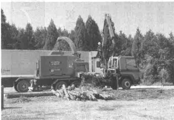
山の中間土場に移動式破砕機を導入
